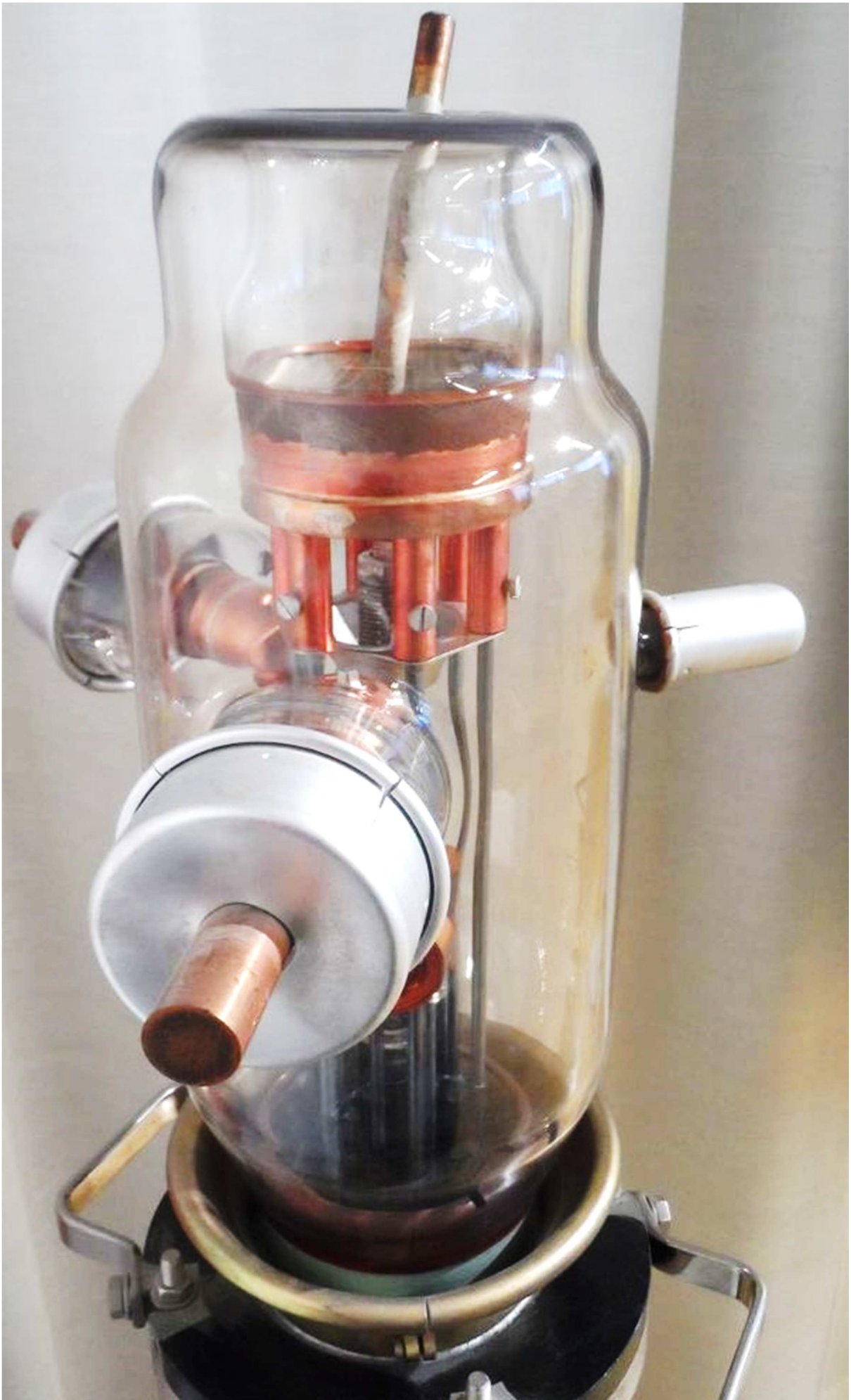
Original-Senderöhre SRW 357 vom Sender 21 (Sender Tegel)
