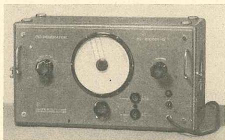
Bild 3. Außenansicht des RC-Summers für 30 bis 300 000 Hz. Links Bereichsschalter. Mitte Frequenzvariation 1:10, rechts Amplitudenregelung, darunter Netzschalter
