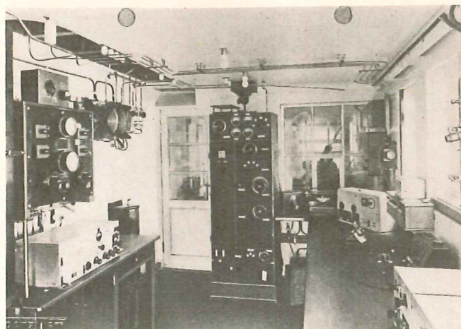
Bild 26: Fahrgastschiff »Bremen«, 1-kW-Kurzwellensender für den Sprechseefunkdienst, Kurzwellenempfänger E 362, 1932; Foto: DBP
