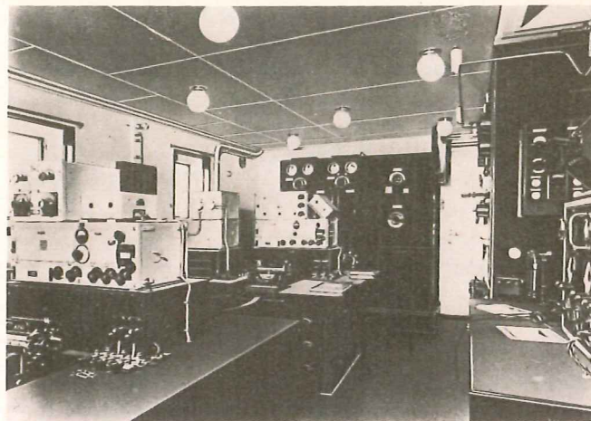
Bild 27: Fahrgastschiff »Europa« 3-kW-Mittel- und Langwellensender, 0,8-kW-Mittelwellensender, 0,2-kW-Mittel- und Grenzwellensender, Dreikreis-Geradeempfänger, 1934; Foto: DBP
