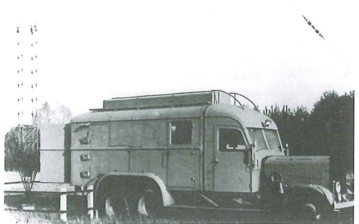
*Antennenabstimmwagen eines fahrbaren Senders in Mainflingen für den Beginn der Sendungen für den Deutschlandfunk auf der Mittelwelle, 1962*
